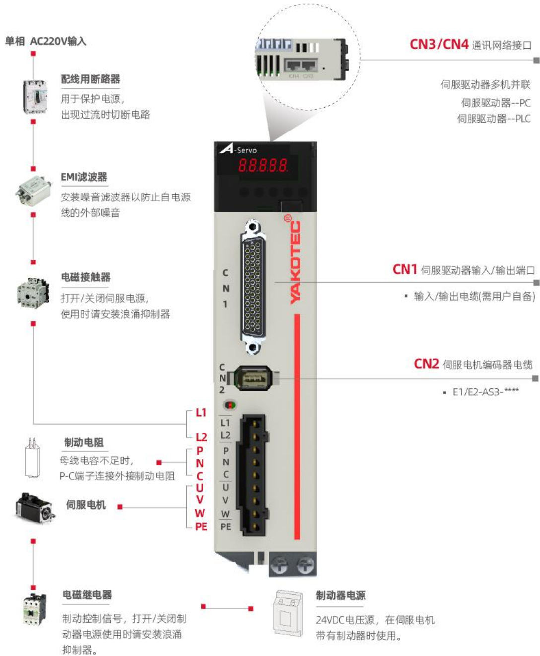
图3-1 200~1000W系统结构图
